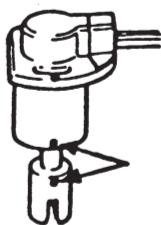
9. Rimontare il sensore sulla forcella di comando, con le marcature rivolte obliquamente indietro verso tribordo. I cavi passeranno allora obliquamente in avanti verso tribordo. N.B.: Accertarsi che il sensore di posizionamento faccia presa sulla forcella di comando.
